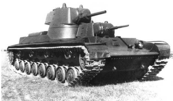
Тяжелый двухбашенный танк СКМ, 1939 г. На этой машине отработали некоторые узлы и агрегаты, использованные на КВ. Фото из книги: Коломиец М.В. Советский тяжелый танк КВ-1. Первые танки Победы, 2017. https://flibusta.herokuapp.com/b/500040/read
