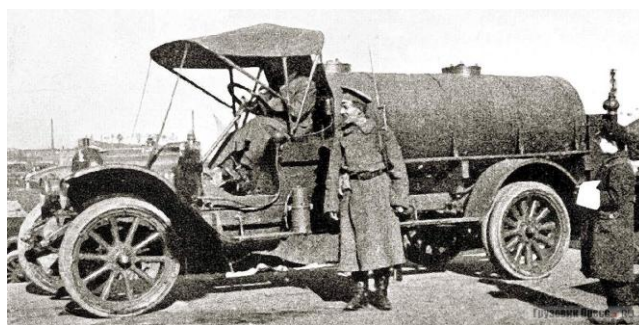
Цистерна-бензовоз на шасси White TAD, 1915 г. http://www.gruzovikpress.ru/article/12315-amerikanske-gruzoviki-white-avtomobili-uavt-v-rossivskov-imperii/
