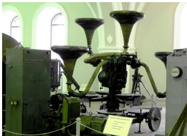
Звукоулавливатель ЗТ-1 (Военно-исторический музей артиллерии, инженерных войск и войск связи,
