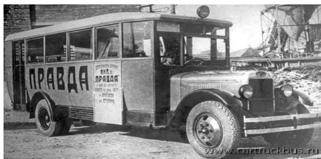
Походная типография на шасси АМО-4 с кузовом автобуса АМО-2, подаренная заводом газете «Правда» на 20-летие издания. Май 1932 г. http://www.cartruckbus.ru
