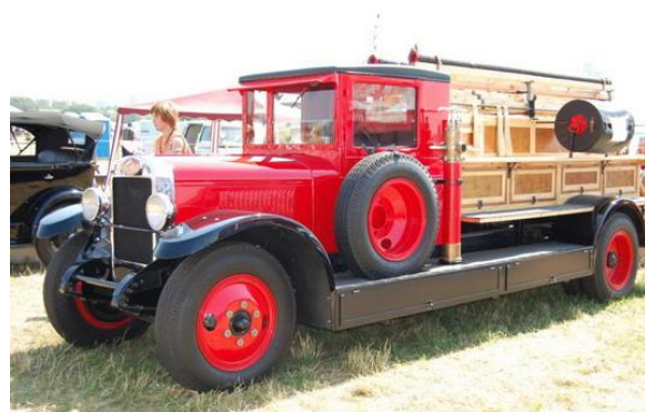
Восстановленный пожарный автомобиль ПМЗ-1 на шасси ЗИС-11 http://nacekemie.ru/forum/viewtopic.php?f=208&t=27509
