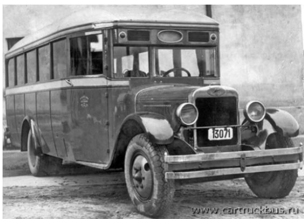
21-местный автобус на шасси АМО-4 с кузовом типа «Люкс» или «Отель», 1932 - 1933 годы http://www.cartruckbus.ru
