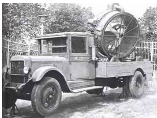
Прожекторная установка на шасси ЗИС-12, 1937 г. (фото из книги Е.Кочнева, 2009).
