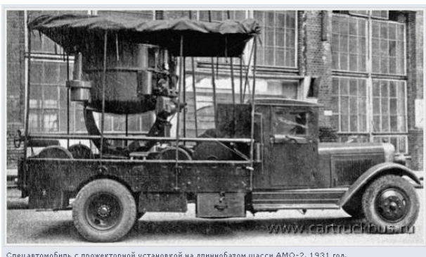
Спецавтомобиль с прожекторной установкой на длиннобазном шасси АМО-2. 1931 год.
