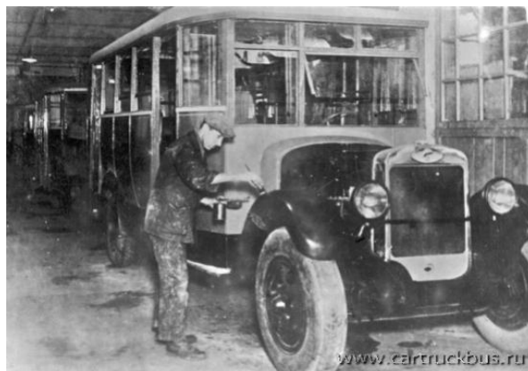
Ранний вариант автобуса на шасси АМО-4 с кузовом прежней модели – АМО-2. Зима 1931-1932 гг. http://www.cartruckbus.ru
