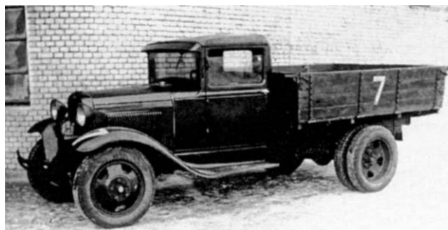
Серийный «Ford AA» московского завода им. КИМ с задними двускатными колесами и отечественной бортовой грузовой платформой, 1931 г. Фото из книги Е.Д. Кочнева, 2009.
