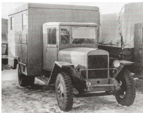
Передвижная электростанция АЭС на базе ЗИС-44. Фото из журнала «Автолегенды СССР. Грузовики, 2019, № 51.
