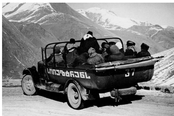
Открытый автобус на шасси ЗИС-5 (предположительно) на горных дорогах Грузии. https://www.geomigrant.com/2017/02/20/автомобили-времен-ссср-выпускаемые-в-грузии/
