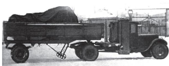
Газогенераторный седельный тягач ЗИС-21Г с полуприцепом НАТИ, 1939-1941 гг. http://www.autotruck-press.ru/articles/580/
